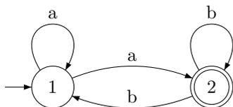
FIGURE 1 – Un exemple d'automate.
