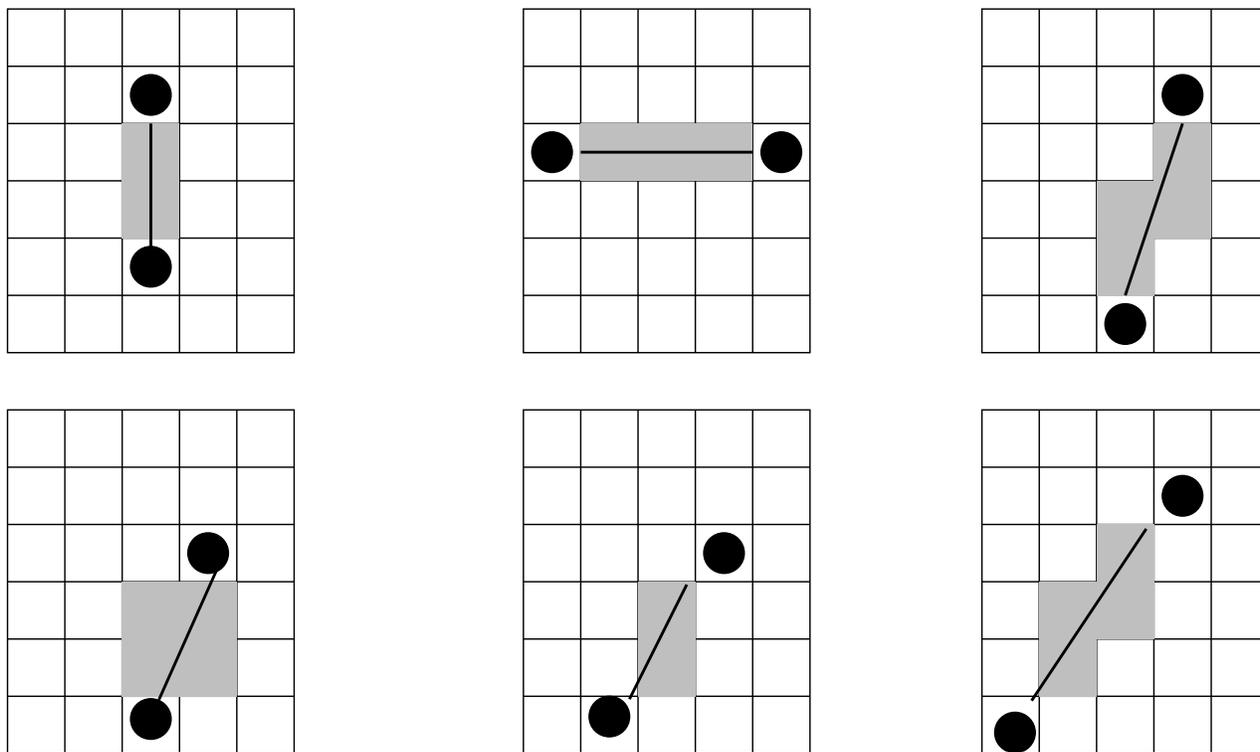
Figure 1 Interprétation de **Between** : les cases grisées sont les  $z$  tels que  $\text{Between}(z, x, y)$
