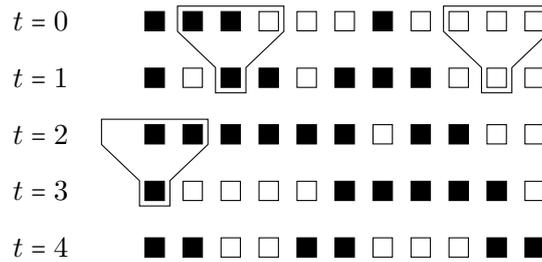
Sont encadrés des exemples d'application de la règle de l'unanimité. À  $t = 1$ , la 3ème cellule est noire car, à  $t = 0$ , les états de cellules 2, 3 et 4 ne sont pas identiques. De façon analogue, l'avant-dernière cellule devient blanche à  $t = 1$  car ses deux voisines ont le même état que le sien à  $t = 0$ . Le troisième cadre souligne le fait que la première cellule considère que sa voisine de gauche est blanche.
