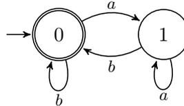
Un mot de  $\{a, b\}^\omega$  n'appartient pas au langage de cet automate si et seulement s'il ne contient qu'un nombre fini de symboles  $a$ . Exploiter cette intuition pour écrire une formule RELTL équivalente à l'automate.
