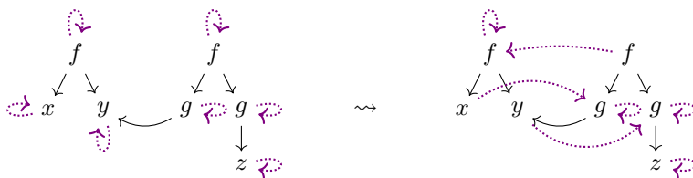
FIGURE 3.2. Étape (2) de l’algorithme d’unification sur les termes d’entrée f(x, y) et f(g(y), g(z)) .
