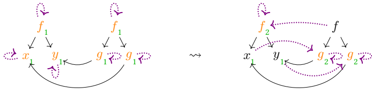
FIGURE 3.7. Étape (2) de l'algorithme d'unification de HUET sur les termes d'entrée f(x, y) et f(g(y), g(x)) .
